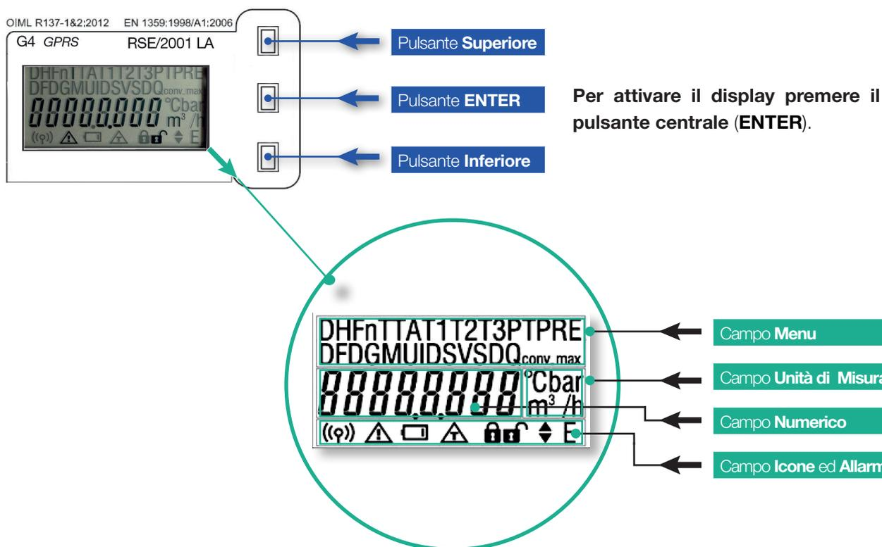
**All'attivazione verrà eseguito un test del display**, al termine del quale verrà visualizzato il menù con il totalizzatore dei volumi alle condizioni di riferimento.
